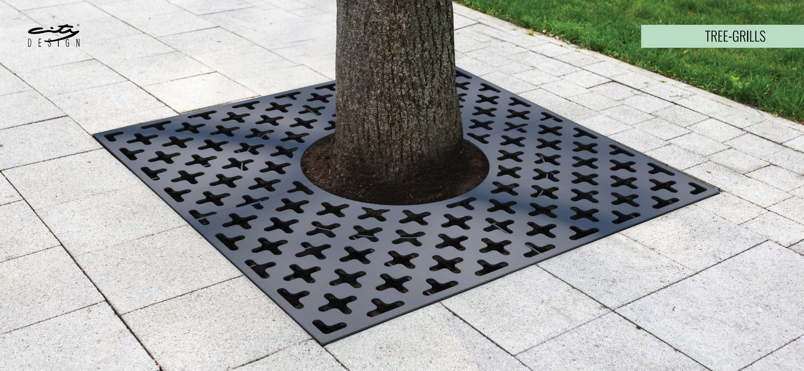
Griglia salvapiante di forma quadrata, disponibile in tre misure, realizzata in lamiera di acciaio con decori a crocette. Per ogni versione è disponibile il relativo controtelaio zincato in profilo d'acciaio ad "L" con staffe per la cementazione. Tutte le parti metalliche sono zionate e verniciate a polvere poliestere termoindurente, ad eccezione del controtelaio.
